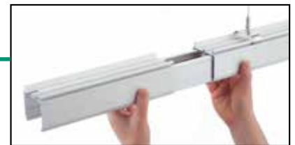
Allineare il terminale con il canale e collegare facendo scorrere le due parti
