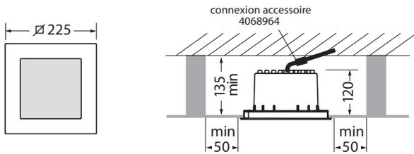
appareil à encastrer dans le plafond en intérieur et en extérieur.
